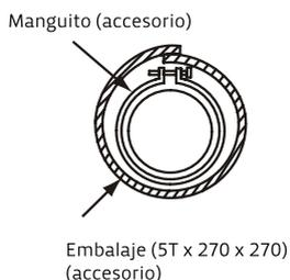
Fig. 6.2. Tubo de desagüe
